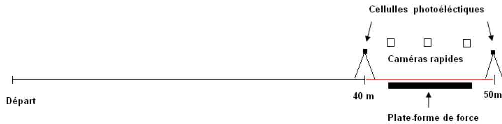
Figure 4: schéma du dispositif expérimental.
